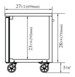
Notas de instalación: Separaciones mínimas en instalación: Tope/laterales: 20.32 cm (8"); Posterior 61 cm (24")°
